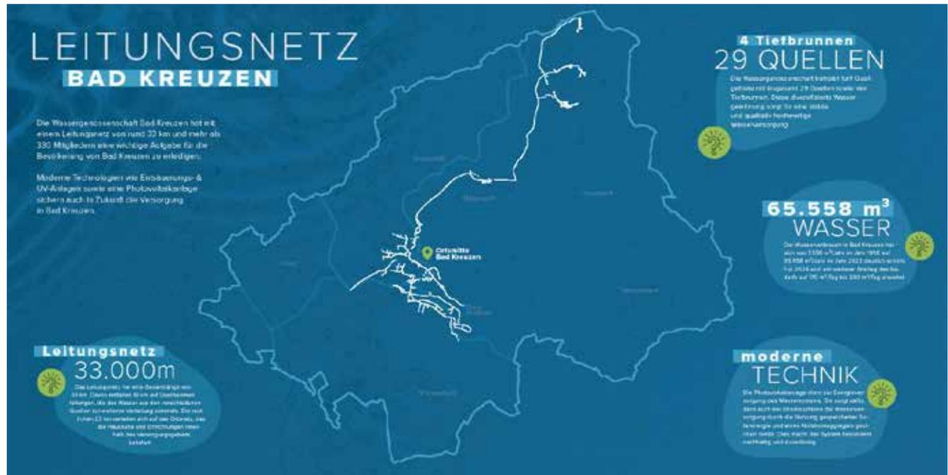
**Die Wassergenossenschaft Bad Kreuzen verfügt über ein Leitungsnetz von rund 33 km und bezieht Trinkwasser aus insgesamt 29 Quellen und 4 Tiefbohrungen.**
